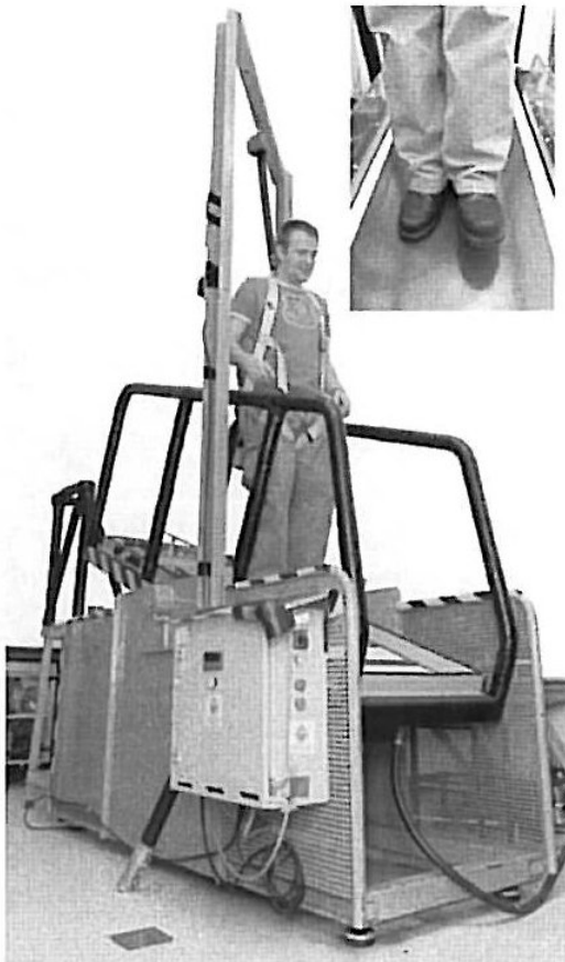
Kuva 1.1. DIN-standardin mukainen ramppitesti.
