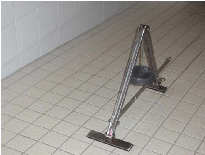
Kuva 3.1. Kenttämittauksissa kitkakertoimen määrittämiseen käytetyn laitteen valokuva.
