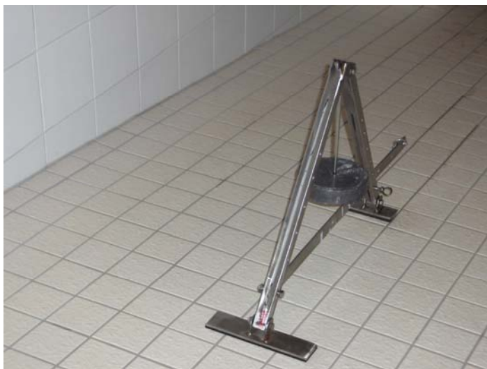
Kuva 1.5. Kenttämittauksissa kitkakertoimen määrittämiseen käytetyn laitteen valokuva.
